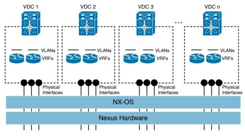
Figure 10-3 VDCs, VLANs, and VRF instances
