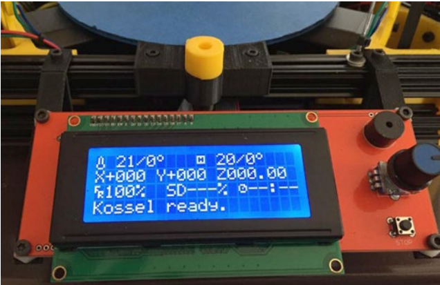
Figure 8-7. LCD panel for Mini Kossel
