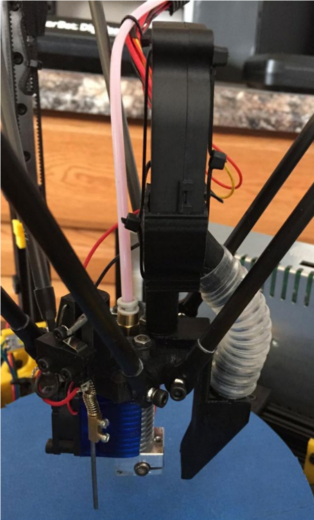
Figure 8-4. Print cooling fan for Mini Kossel
